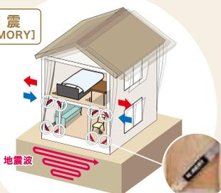
地震エネルギーを装置が吸収。建物の揺れが抑えられるため、構造躯体へのダメージが軽減されます。
